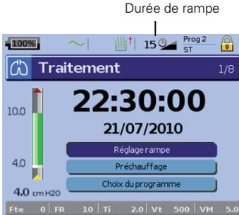
La rampe est une option que votre clinicien peut activer en réglant une durée de rampe maximale. La rampe a pour but de rendre le début du traitement plus confortable et correspond au temps qu'il faut pour que l'appareil passe d'une pression initiale basse à la pression de traitement. Voir « Menu Réglages : Options », page 16.
