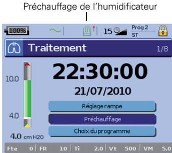
Vous pouvez utiliser la fonction de préchauffage pour préchauffer l'eau dans l'humidificateur avant de démarrer le traitement. L'humidificateur est automatiquement détecté lorsque l'appareil est mis sous tension. Une option de préchauffage de l'humidificateur est aussi fournie dans l'écran *Traitement*. Si l'humidificateur chauffe, le symbole correspondant s'affiche en haut de l'écran LCD. Pour plus d'informations, reportez-vous au guide d'utilisation du H4i.
