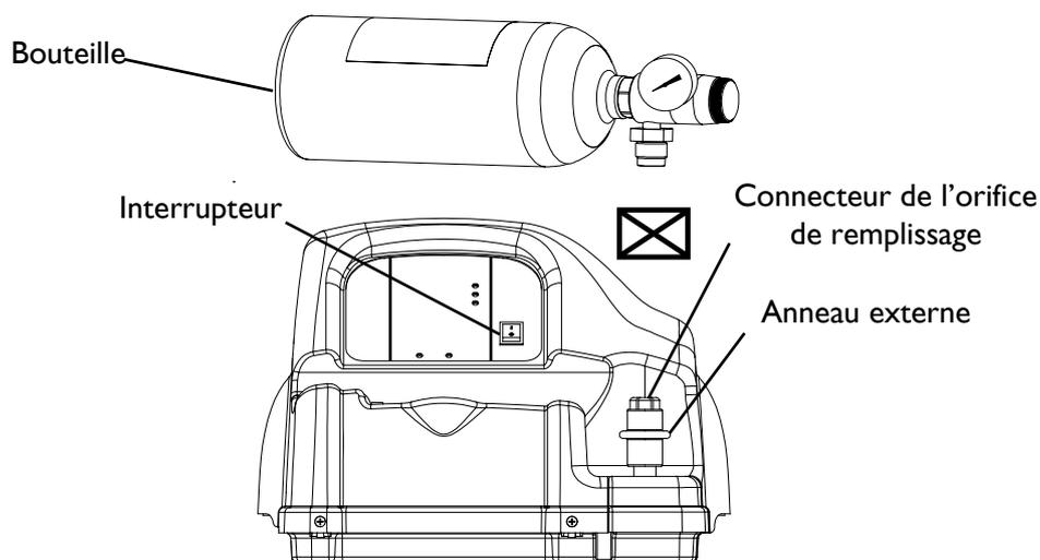
*NOTE : Le couvercle du connecteur de l'orifice de remplissage n'est pas représenté pour plus de clarté.*
