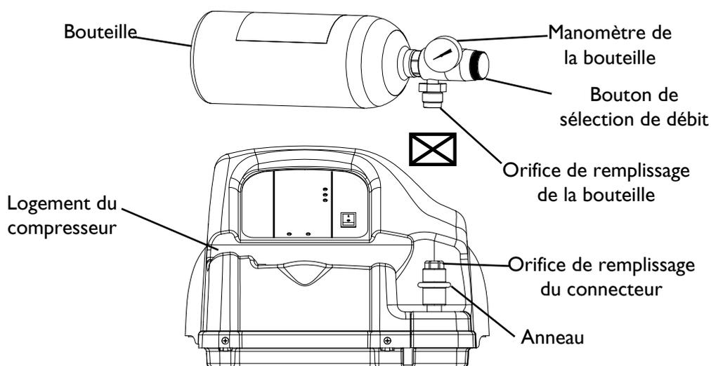
*NOTE : Bouchon de l'orifice de remplissage non représenté pour plus de clarté.*
