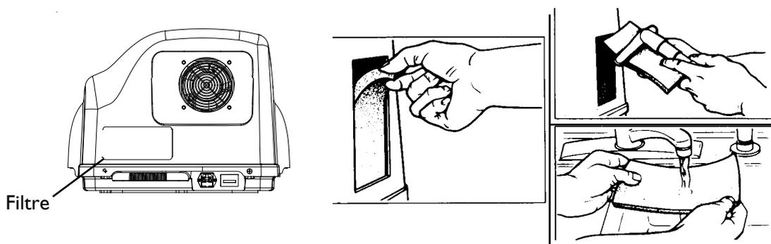
FIGURE 1 – NETTOYER LE FILTRE DU COMPRESSEUR
