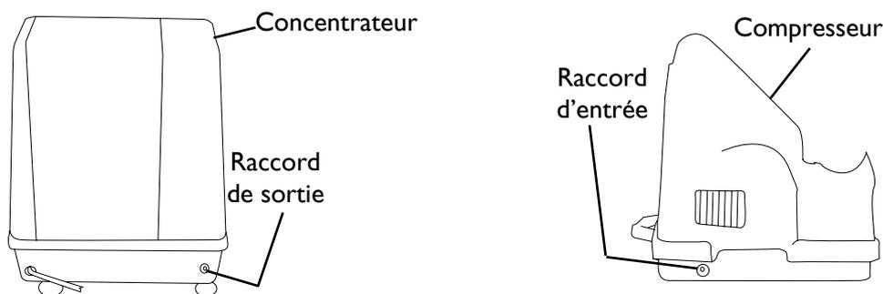
FIGURE 3 – CONNECTER LE COMPRESSEUR SUR LE CONCENTRATEUR
