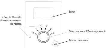
Remarque : Reportez-vous au paragraphe Réglage/modification des réglages de l'appareil de ce guide pour régler la luminosité de l'icône de l'humidificateur ou des voyants de réglage sur faible ou sur une extinction au bout de 30 secondes.
