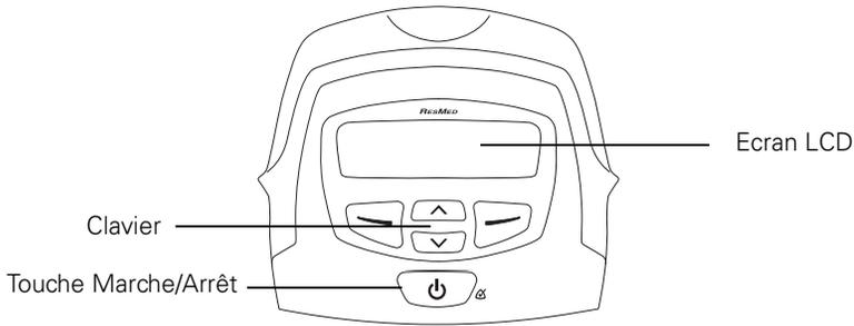
Le panneau de contrôle de la S8 II comprend un écran LCD, qui permet d'afficher les menus et les écrans de traitement, ainsi qu'un clavier pour la navigation dans les menus et pour le traitement.
